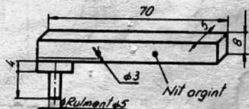
7 Bară dreptunghiulară (1x0x). Axul (φ Rulment) dacă e necesar poate fi montat prin sudură
