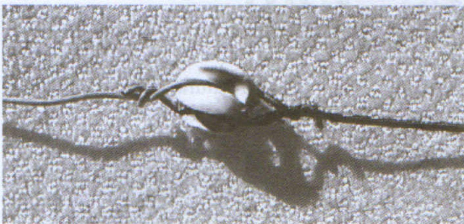
A treia încercare, același izolator, cablul de ancorare de 1,5mm pătrați, dar bucla răsucită se scurtează la 7cm.
