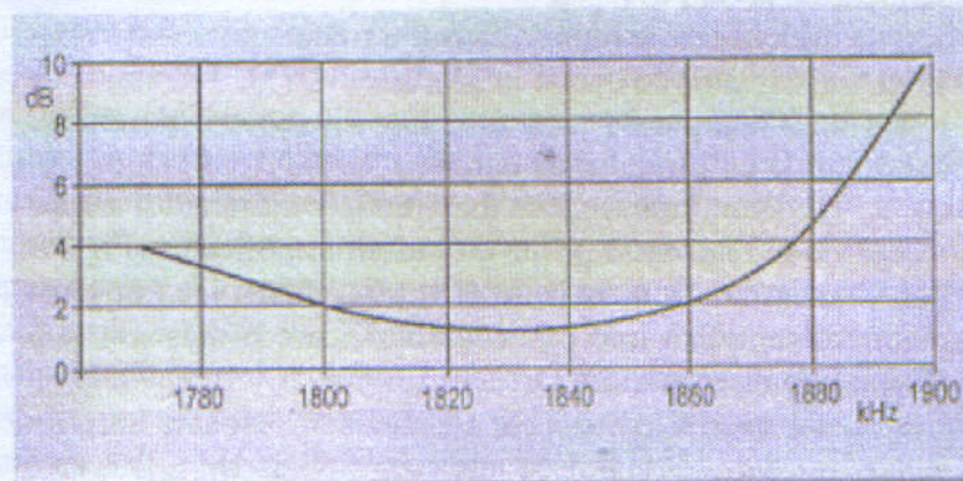
Îmbunătățirea recepției în banda de 160m este o dorință a tuturor celor ce lucrează în această frecvență. DM2ARD - Fritz Traxler propune în revista CQ DL nr. 7-2010 un filtru trece bandă simplu (Fig.1) format din trei celule acordate pe 1830kHz și cuplate capacativ prin 2 condensatoare ceramice (C1/1 și C2/3).
