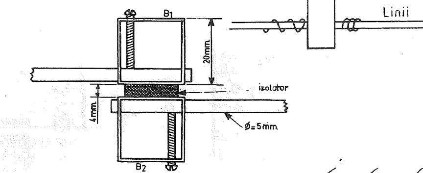
Prin plăcuțele izolatoare (care suportă elementele E) trece o sfoară din material plastic (ca cele de întins rufe) care susține greutatea antenei. Tot prin plăcuța izolatoare trec și două fire paralele la distanță  $d=18\text{mm}$  ce formează linia de alimentare. De pe această linie, cu fire încrucișate, se alimentează fiecare element E (fig. 4). Extremitățile fiecărui element E sunt legate de un suport (sfoară) care se fixează pe piloni; ajung 6 puncte de susținere ale antenei.
