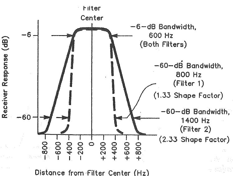
Cîteodată, din diferite motive, filtrele sunt caracterizate în puncte diferite și acest lucru trebuie avut în vedere atunci cînd comparăm caracteristicile mai multor filtre.
