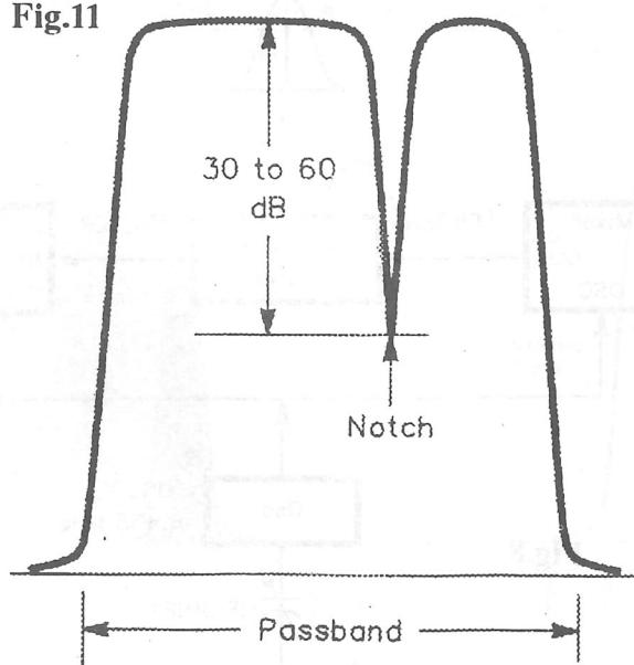
eficient în eliminarea interferențelor de bandă îngustă, cum sunt semnalele de telegrafie sau purtătoarele nemodulate care se găsesc în interiorul benzii de trecere a lanțului de FI.
