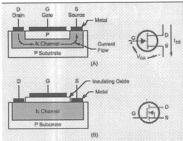
**Fig. 1 - Construcția unui JFET (A) și a unui MOSFET (B), alături de simbolurile lor.**
