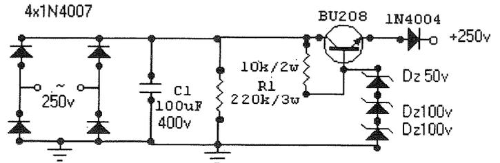
Alimentatorul, cu toate tensiunile necesare tubului respectiv: 1100V, 250 V.
