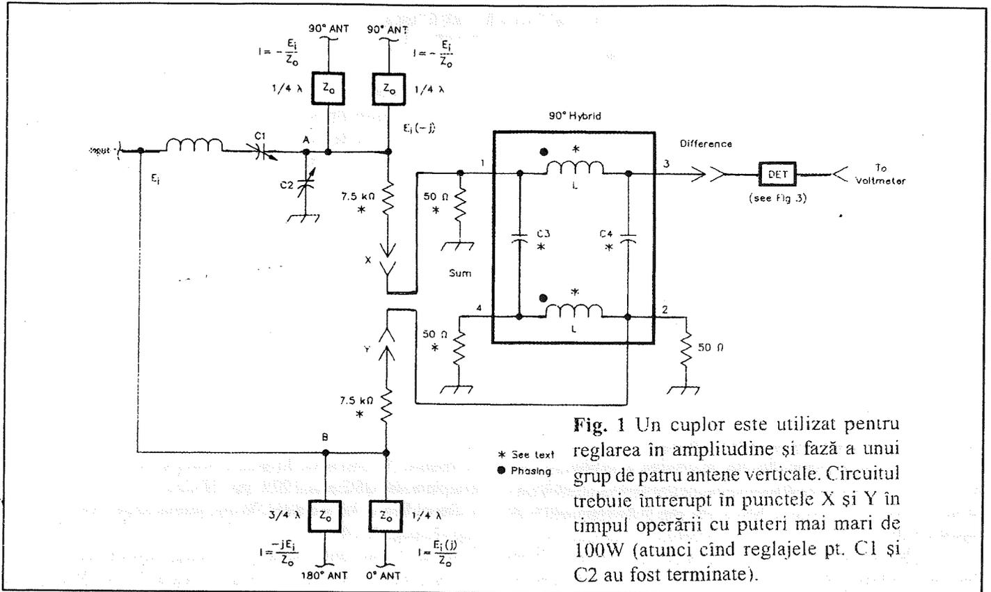
**Fig. 1** Un cuplor este utilizat pentru reglarea în amplitudine și fază a unui grup de patru antene verticale. Circuitul trebuie întrerupt în punctele X și Y în timpul operării cu puteri mai mari de 100W (atunci când reglajele pt. C1 și C2 au fost terminate).
