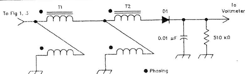
Fig. 3 Un detector simplu cu diodă, bun de utilizat cu schema din Fig. 1. D1 este 1N34 sau 1N3666 (N.Trad. sau EFD108, Ge sau Schotky etc.). T1 sunt transformatoare 4:1 realizate prin bobinarea bifilară a 5 spire din conductor 0,4mm pe două toruri FT50-77.
