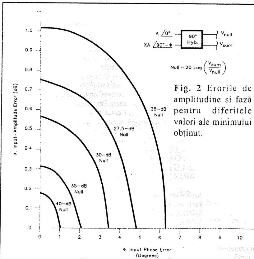
**Fig. 2** Erorile de amplitudine și fază pentru diferitele valori ale minimumului obținut.
