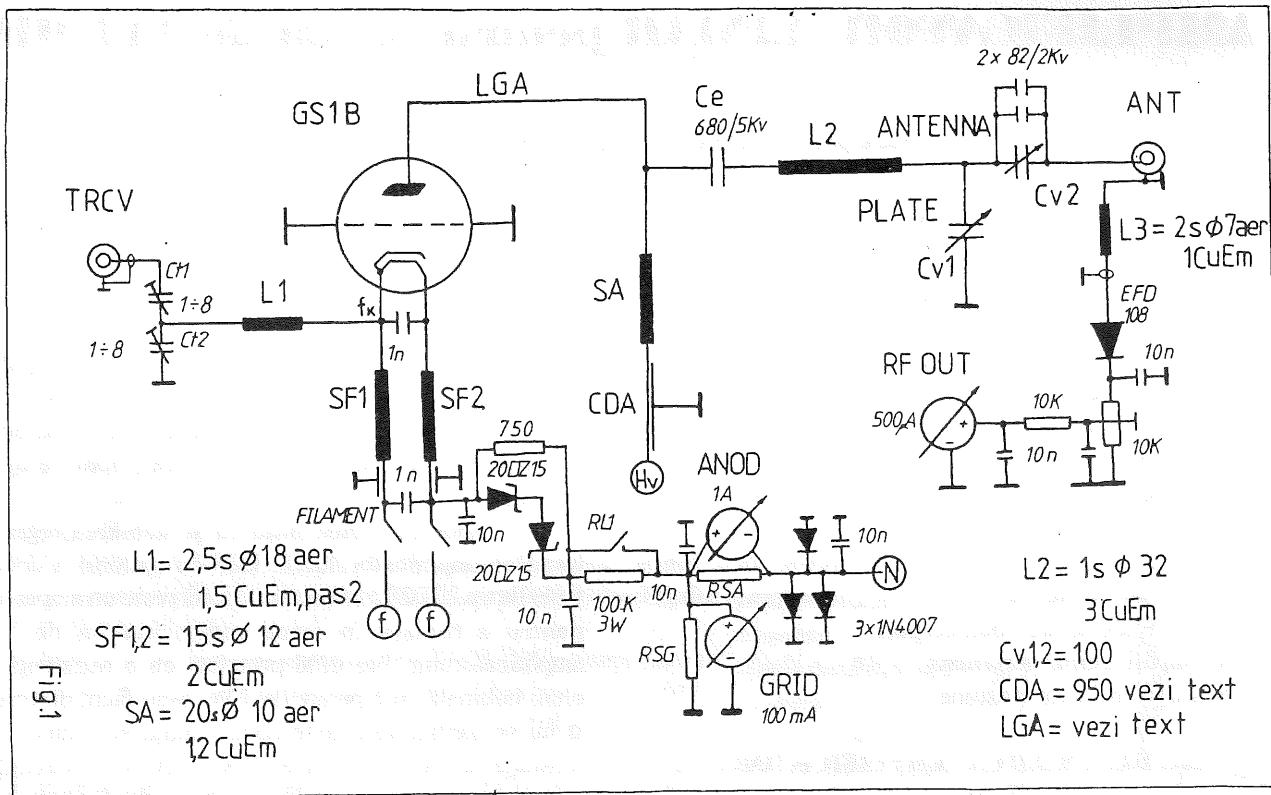
Condensatorii Cv1,2 au fost testați la o tensiune de 3 Kv efectiv în alternativ ca nu cumva să străpungă și dacă nu, este suficient pentru montajul de față.
