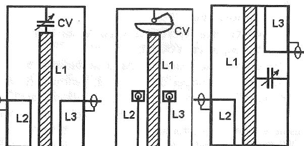
Buclele de cuplaj, din conductor de 1,6mm, sunt la cca 1,6mm distanță de linia acordată (Fig.3). Traducere din The Radioamator Handbook 1971.
