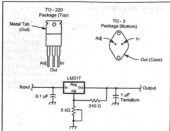
**Fig. 3 –** Stabilizatorul reglabil cu trei terminale LM317 este foarte versatil și robust. Condensatoarele sunt necesare pentru a ne asigura că amplificatoarele interne rămân stable în toate împrejurările. Rezistorul de  $240\Omega$  limitează curentul care trece prin potențiometrul de  $5\text{k}\Omega$ . Acest stabilizator are o tensiune de ieșire reglabilă de la  $1,2\text{V}$ , până la un maxim ce se situează cu cca.  $3\text{V}$  sub tensiunea de intrare.
