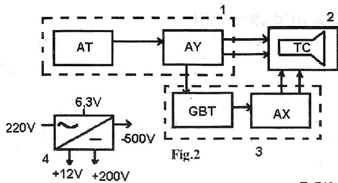
In Fig. 2 este prezentată schema bloc a osciloscopului realizat. Ea este compusă din patru module constructive și anume: 1/ modulul atenuatorului de intrare (AT) și al amplificatorului AY
