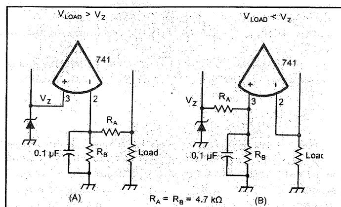
**Fig. 2 – A:** Divizorul de tensiune, format din  $R_A$  și  $R_B$ , determină AO să comande tranzistorul serie în aşa fel încât tensiunea pe sarcină să fie mai mare decât tensiunea diodei Zener  $V_Z$ .
