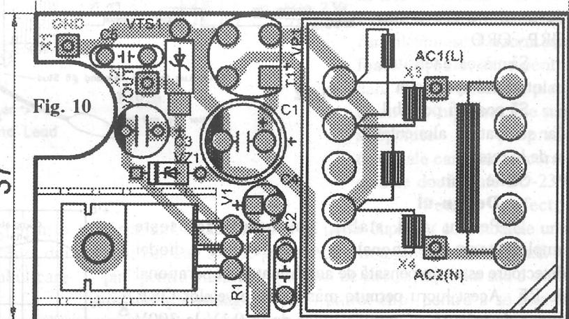
Schema se pretează la modificări pentru o altă tensiune de ieșire (de exemplu 12V pentru un transceiver de mică putere), utilizând pentru V2 un LM1084-ADJ cu rezistoare externe pentru 12V la ieșire, iar pentru V1 un stabilizator (sau o sursă separată) reglată pentru 13,8V la ieșire.
