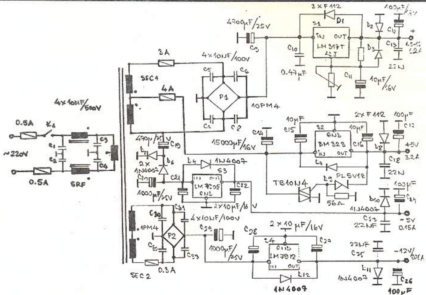
prevăzut un filtru de rețea clasic SRF + C1 ... C4 iar pe bornele de ieșire sunt lipite scurt baterii de condensatori: C12/C13, C17/C18, C23/C24 și C25/C26. Alimentatorul are și o protecție grosieră prin siguranțe fusibile în primar și secundar.
