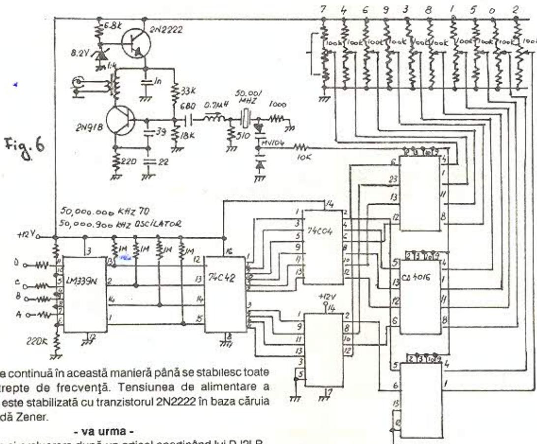
Se continuă în această manieră până se stabilesc toate cele zece trepte de frecvență. Tensiunea de alimentare a oscillatorului este stabilizată cu tranzistorul 2N2222 în baza căruia se află o diodă Zener.
