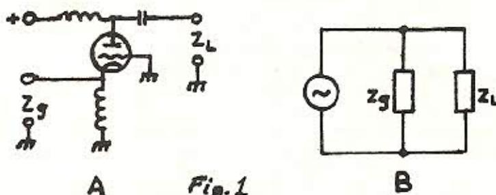
aproximație, impedanța de catod a etajului, cu condiția ca să exprimăm transductanța în A/V și nu în mA/V cum este dată în cataloge. Să nu uităm că  $Z_g$  este în paralel cu  $Z_L$ .
