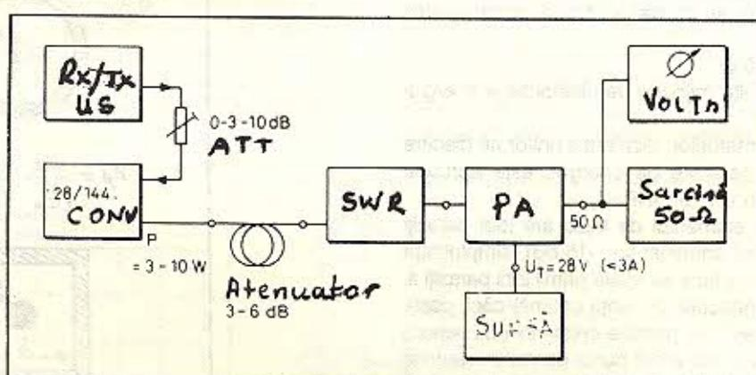
Fig. 9 Circuitul de testare și măsurare a amplificării
