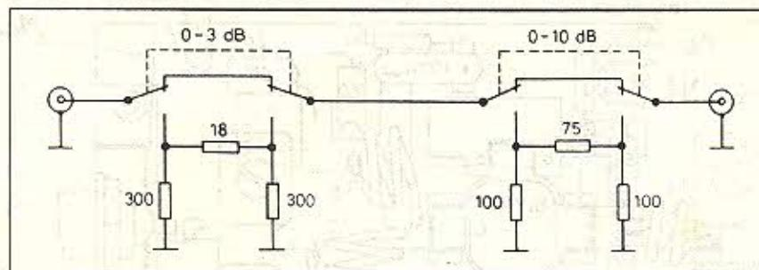
Fig. 10 Realizarea unui atenuator în trepte: 0-3-10dB
