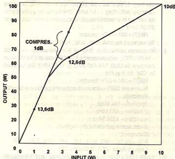
cu numai 9 dB. În graficul prezentat (fig. 2) la input de 3,5 W obținem 64 W out în loc de 80 W căt ar fi trebuit să fie dacă amplificarea ar fi absolut liniară.
