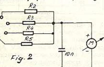
din 6 bucăți rezistențe 300 Ω/1 W montate în paralel între două plăcuțe de circuit imprimat în formă de disc. Pentru a nu radia RF, sarcina se ecranează montându-se într-o cutie metalică.
