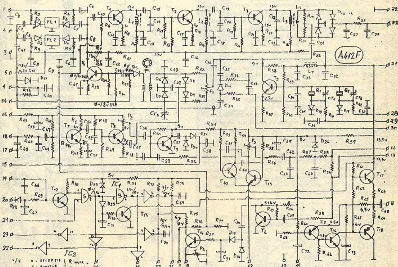
pentru autocontrol în telegrafie (T<sub>10</sub> și T<sub>11</sub>). De la cosa 14 se conectează potențiometrul de volum al căruia cursor acționează intrarea amplificatorului AF pe cosa 11 (T<sub>15</sub>, T<sub>16</sub>, T<sub>17</sub> și T<sub>18</sub>). O parte din tensiunea de AF este prevăzută de către T<sub>6</sub>, care realizează o amplificare suplimentară, apoi semnalul este redresat și filtrat și comandă amplificatorul de AGC și semetru (T<sub>14</sub>).
