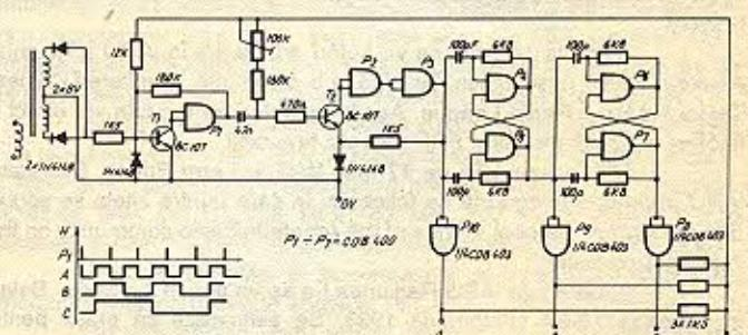
Circuitul format din T și poarta P, formează un generator triger sincron cu impulsurile pozitive provenite pe baza lui T, după redresare dublă alternanță.
