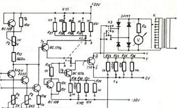
Din  $P_2$  se reglează tensiunea pe oglinda de curent să fie de 1 V. Toate rezistențele din schema de măsurat este bine să aibă toleranță de 1%. Rezistențele de pe comutator  $K_4$  să fie de 1 W.
