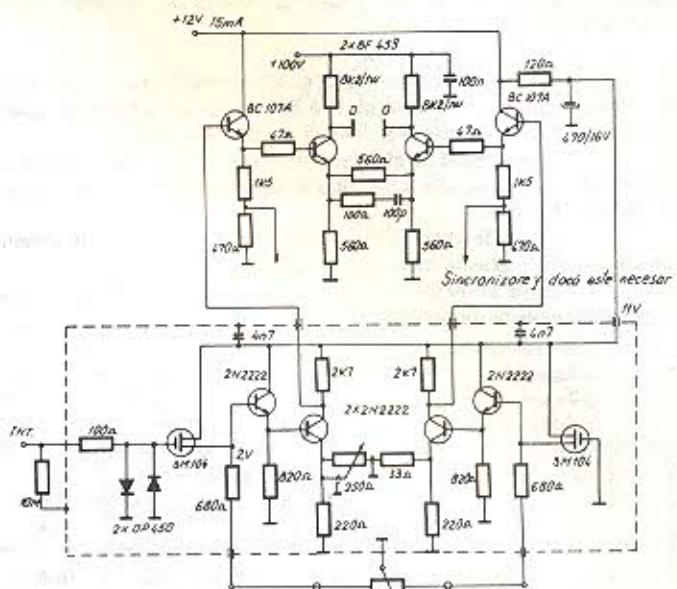
Bornele de intrare se conectează prin cablu ecranat cît mai scurt cu putință și cu ecranul legat la blindaj. Prin ecran să nu circule curenti. Dacă amplificarea este prea mare se montează un divizor de atenuare. Diodele DP450 pot fi înlocuite cu 1N4148.
