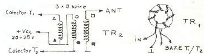
TR<sub>2</sub> .... 3 x 8 spire bobinate simultan pe un tor de ferită de secțiune 0,8-1,5 mm<sup>2</sup> cu sîrmă CuEm de 0,8 mm.
