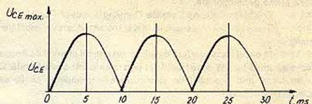
Curentul de colector va exista deci numai pe durata 5 ms de la 0 + 5 de la 10 + 15; 20 + 25 și.m.d. cind tranzistorul primește curent în bază. Curentul de colector se închide la sursă prin rezistență de măsură RM fig. 1 și produce pe aceasta o cădere de tensiune ce este afișată și măsurată pe axa y a osciloscopului. Pentru a măsura curentul pe rezistență RM osciloscopul se calibrează cu amplificarea ca la valorile din tabel:
