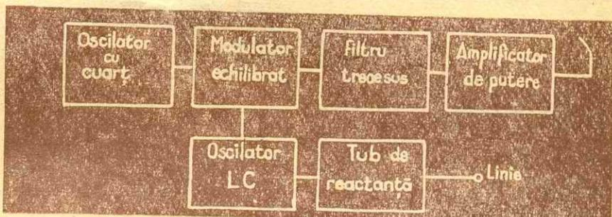
Schema bloc a unui emițător de telegrafie cu deviație de frecvență.
