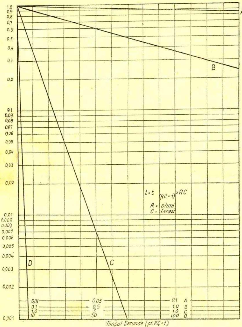
temp ce corespunde la  $1/2 \times$  frecvență, adică  $RC$ -ul este astfel dimensionat, încit schimbarea voltajului de la 0 la  $V$  sau de la  $V$  la  $0$  durează  $1/2 \times$  durata unui ciclu din frecvență pe care oscilează circuitul.
