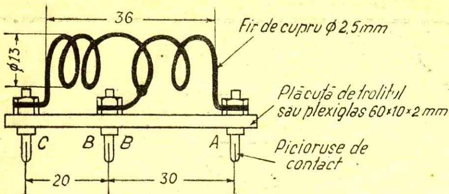
Fig. 4. Aspectul constructiv al bobinei pentru 56 MHz.
