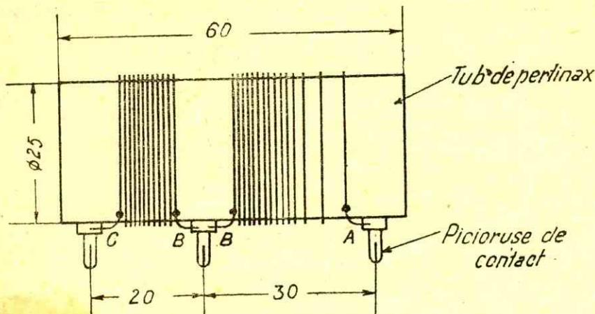
Fig. 2. Aspectul constructiv al bobinelor pentru 1,75... 28 MHz.
